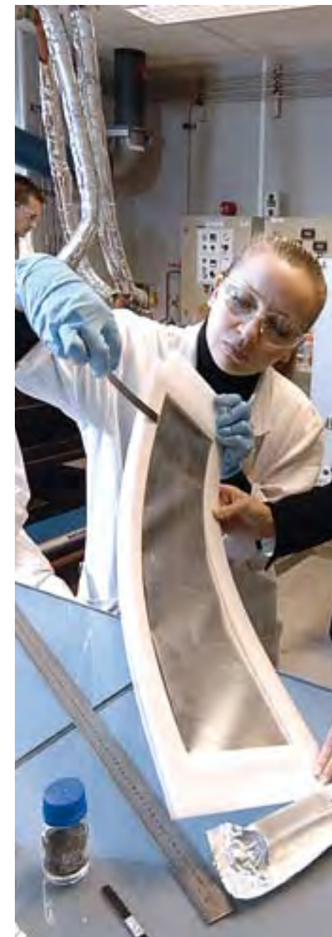
Des chercheurs travaillent sur les prototypes de batteries pour le stockage des énergies au LITEN
